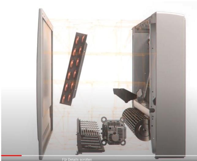
*Innenansicht eines „Condiline Fancoils DXH“ von Arbonia: der großflächige Wärmetauscher sorgt in Verbindung mit dem Tangentialventilator für die gleichmäßige, energieeffiziente Wärmeverteilung, der Filter im unteren Ansaugbereich für eine staub- und pollenfreie Luftqualität. Das wissen nicht nur Allergiker zu schätzen.*
